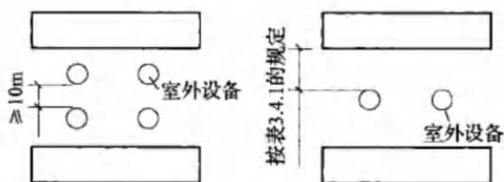
图 1 有室外设备时的防火间距
